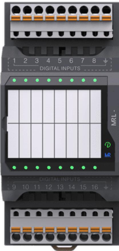
Модуль расширения Segnetics MRL предназначен для увеличения числа каналов в системах автоматизированного управления и сбора данных.
