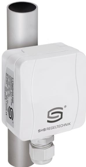
Работаем по всей России, гарантия и качество производителя! Датчик THERMASGARD ALTF 2 является накладным термометром сопротивления для труб с пассивным выходом, стяжной лентой и клеммным коробчатым корпусом из пластика с высокой ударной вязкостью и крышкой корпуса с быстроворачиваемыми винтами.
